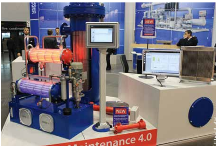
Auf der Hannover Messe 2017 stellte Universal Hydraulik eine komplett vernetzte Hydraulikanlage mit Tank, Kühler, Heizung, Sensorik und Steuerung vor.
